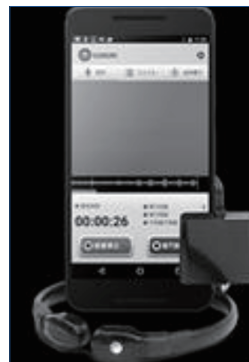
Fig.2: 画面上での情報 専用のアプリを使用し、 嚥下回数、嚥下時間など 情報の表示、記録が可能である。
