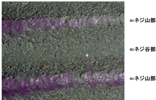
図2 キャビテーション噴流による洗浄後のフィクスチャー表面
