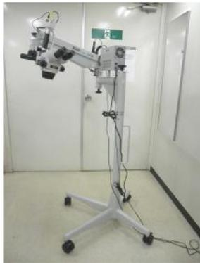
マイクロスコープの特徴は、3~20倍に拡大し細部を良く見えるようにします。さらに明るい照明で暗い深部が見えるようにします。そうした拡大され明るく見やすくなった根管内部の様子を録画して記録できます。
