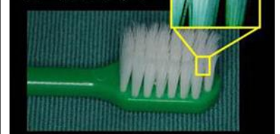
図2: 毛先が針状のものは、先端がカールしやすい
