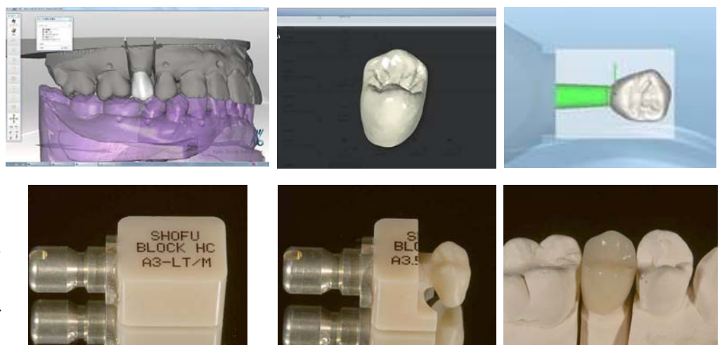
図 上段:CADソフトを用いたクラウンのデザイン。 下段:左からCAD/CAM用ブロック、ブロックの削り出し直後、クラウンの仕上げ後 (前技工室責任者、鍛治田氏のご厚意による資料)
