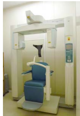
図1 歯科用コーンビームCT装置1： 歯および周囲の構造を立体的に把握します。座った状態で撮影し、装置が顔の周りを360°回転します。この装置は主に小さい範囲に使用しています。
