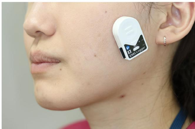
図1：小型の歯ぎしり検査装置
