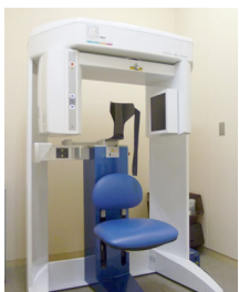
図2 歯科用コーンビームCT装置2：顎骨の構造を立体的に把握します。座った状態で撮影し、装置が顔の周りを360°回転します。この装置は主に矯正治療やインプラント目的に使用しています。
