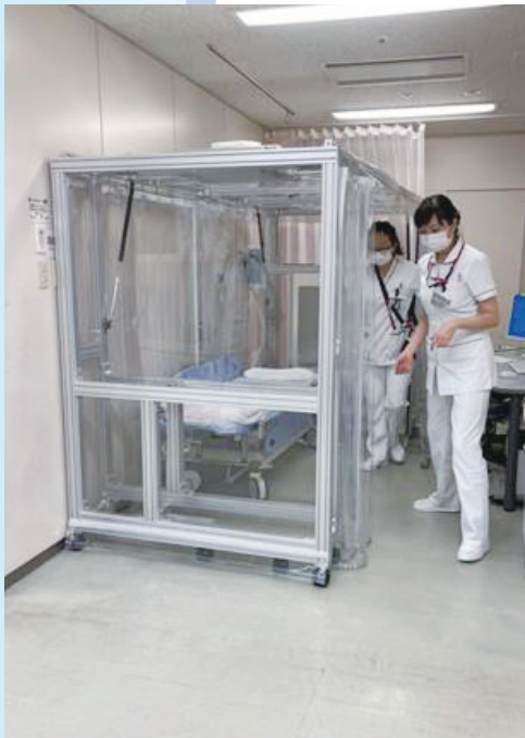
救急室内に設置された隔離施設 COVID-19にも対応しています
