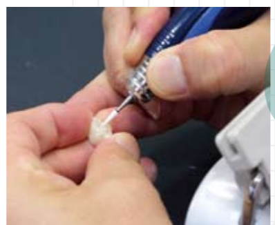
削り出された歯を細かく削りながら調整。ここは従来通り手作業との職人技となる。
