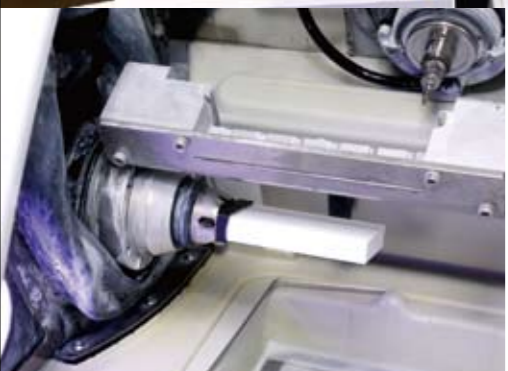
CAMで素材のジルコニアのブロックから削り出す。ジルコニアには品質を証明するシリアルナンバーが付いている。
