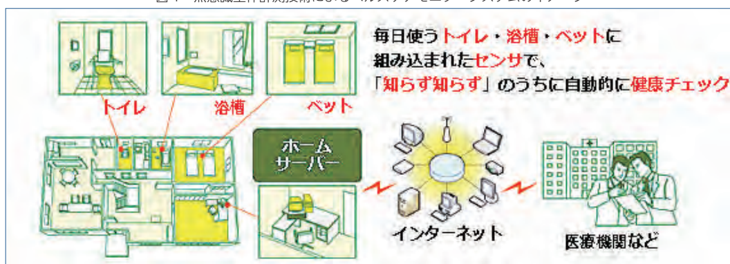
図2 容量結合型電極を用いた浴槽の無意識心電の呼吸計測システムの概要
